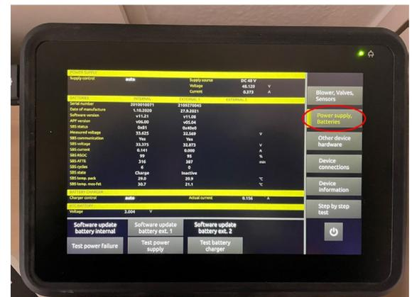
2. Wählen Sie mit der Schaltfläche **Software update battery ext. 1** um den Akku an der Schnittstelle E1 zu aktualisieren.
